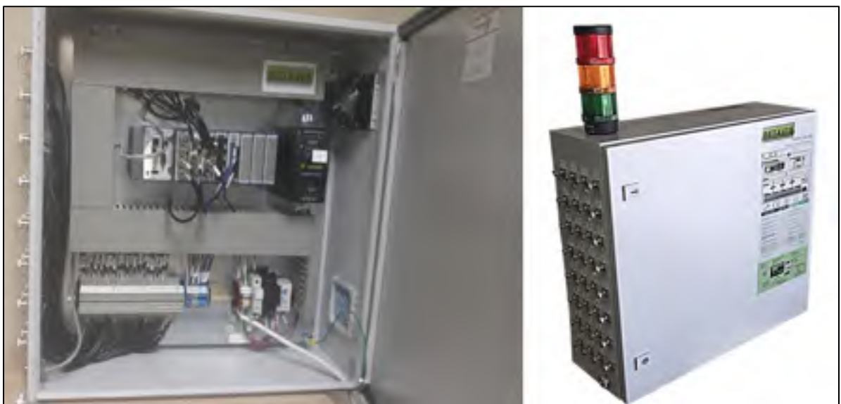
Figure 6.4 Prototype réalisé et intérieure de l'armoire électrique
