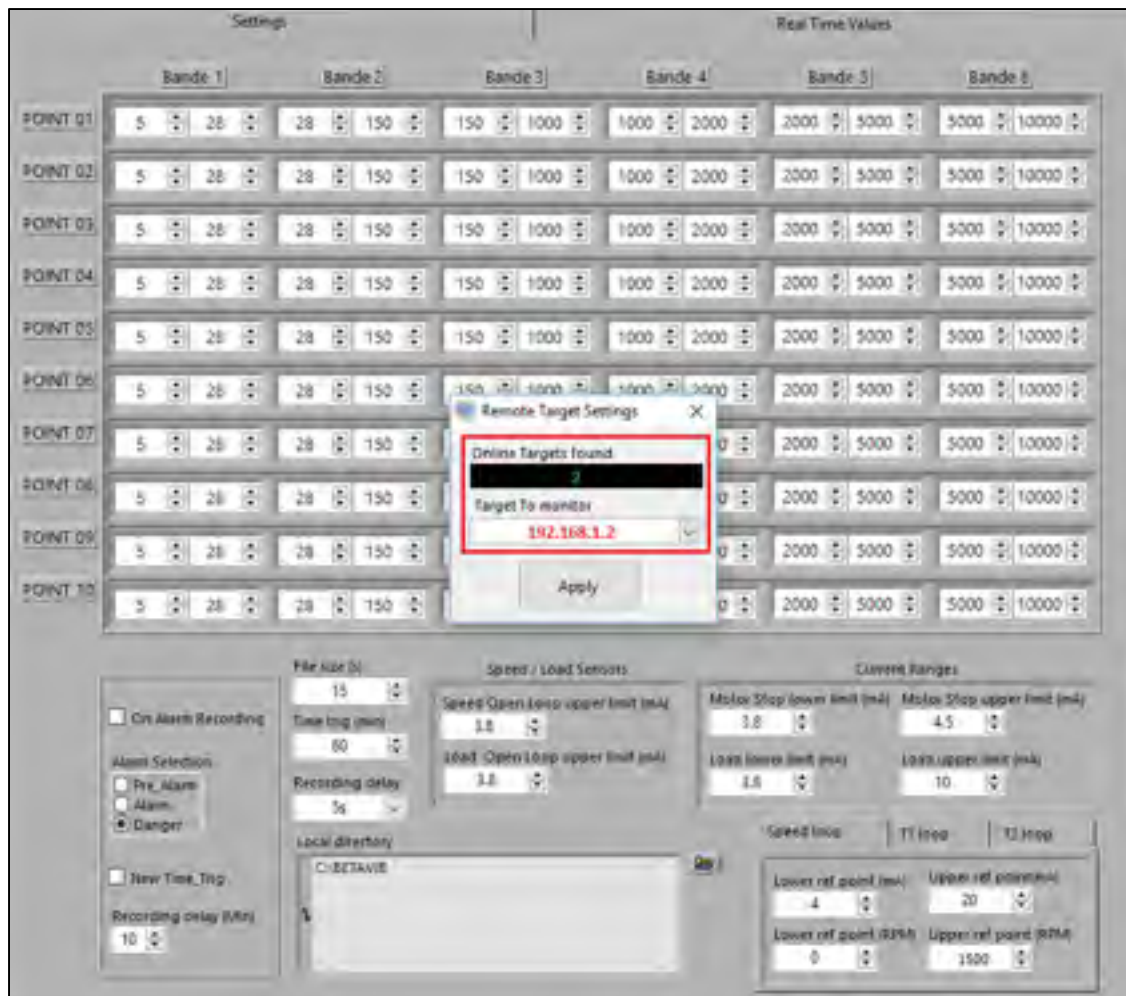
Figure 5.12 Identification d'un contrôleur sur le réseau par IP statique
