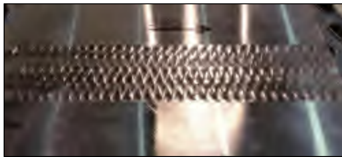
Figure 4.4 Empreintes de martelage visibles sur un dépôt soudé, surfacé puis martelé (DSM)
