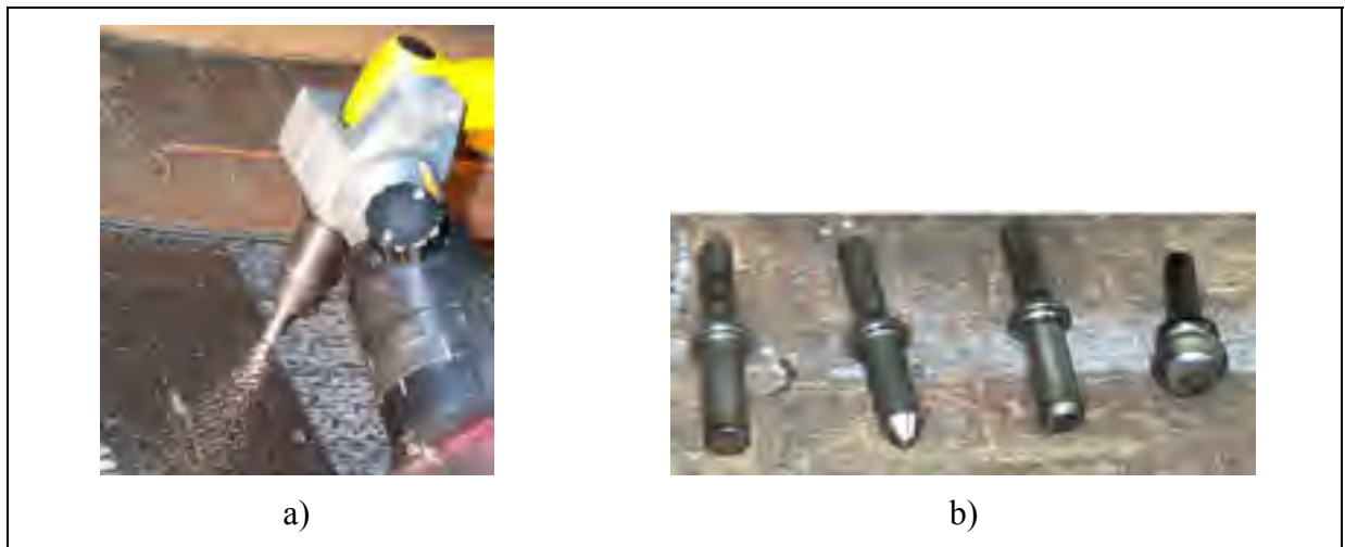
Figure 1.15 a) Outil de martelage robotisé b) pointes de martelage avec surfaces de contact variées (Morin, 2001)
