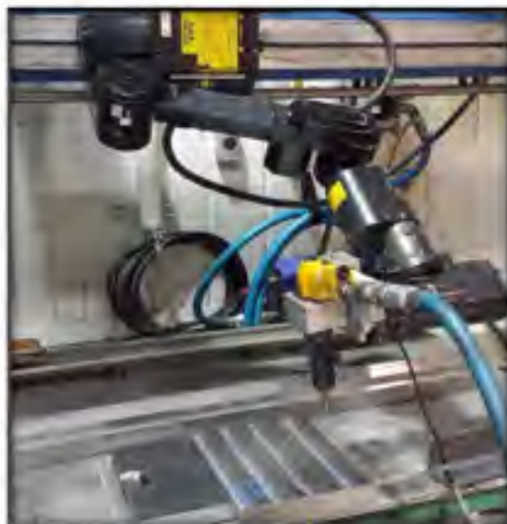
Figure 3.4 Bras robotisé SCOMPI équipé avec l'outil de martelage
