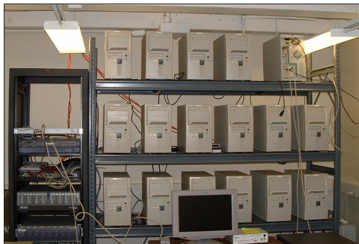
Figure 1.1 Exemple de cluster Beowulf. Tirée de (Senning, 2016).
