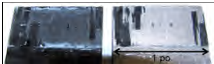
Figure 2.18 Faciès de rupture typique d'une éprouvette de joint composée d'une plaquette d'acier, une plaquette en matériau composite A et de l'adhésif Z
