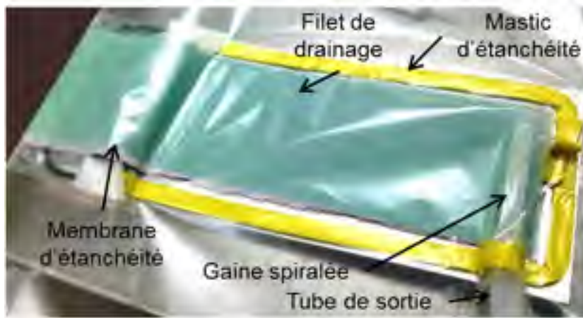
Figure-A X-4 Ajout du matériel d'infusion
