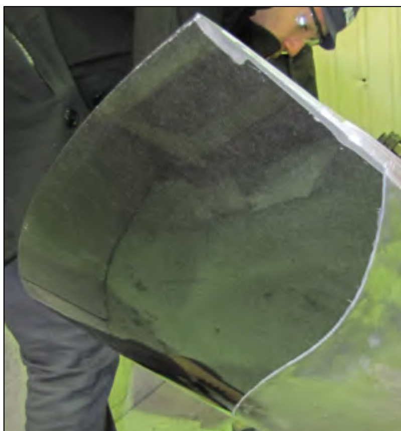
Figure-A XIV-3 Extrémité ceinture du bord de fuite de l'aube (côté extrados)
