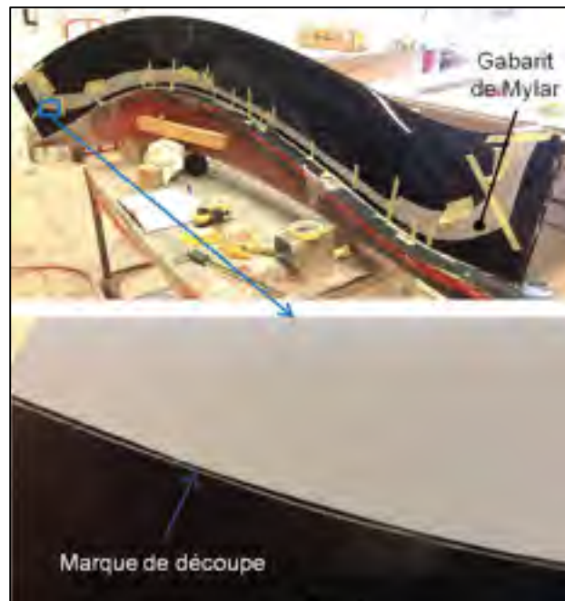
Figure 5.15 Positionnement et collage du Mylar sur le côté intrados de la coque (haut). Grossissement du marquage de découpe (bas).
