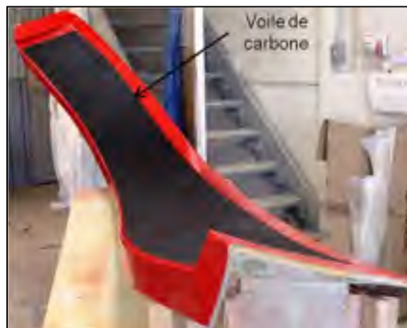
Figure 5.11 Peau de la coque après son laminage sur la pièce extradados du moule femelle
