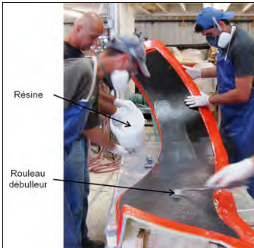
Figure 5.12 Laminage des quatre couches sur la pièce extrados du moule femelle
