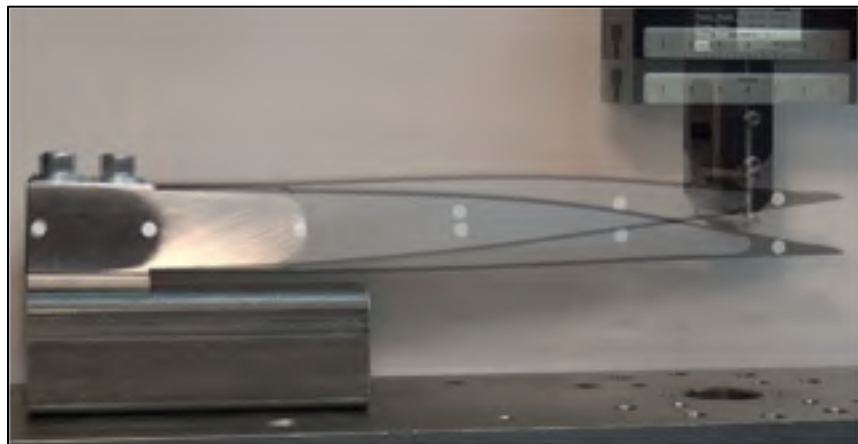
Figure 4.9 Superposition des images du préprototype sec au début et à la force maximale lors de l'essai de flexion
