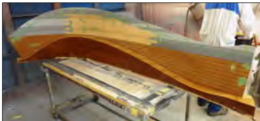
Figure-A VIII-4 Côté intrados du moule modèle avec défauts corrigés à la pâte (traces vertes) et avec agent de scellement
