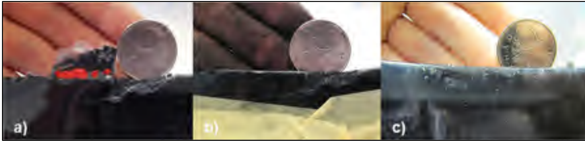
Figure-A XIII-3 Défaut du bord de fuite de la coque 1 après le démoulage (a), pendant la correction (b) et après la correction (c)
