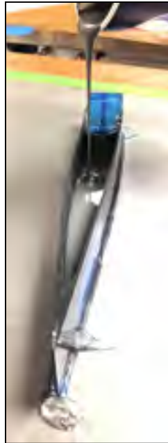
Figure 4.6 Coulée du coeur d'époxy L
