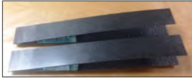
Figure 4.4 Coques faites d'époxy B pendant l'arrachage des membranes d'infusion
