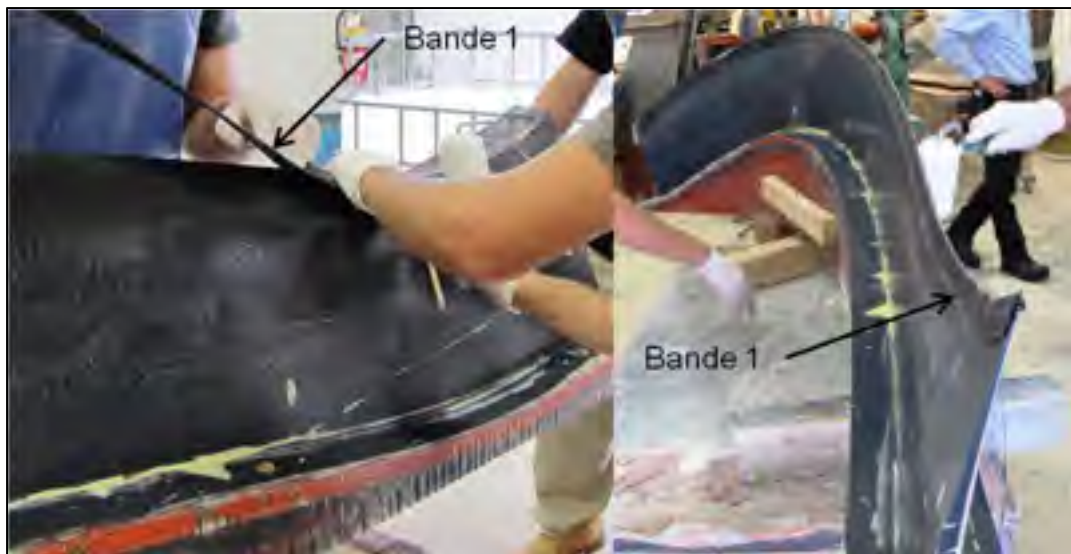
Figure 5.13 Laminage de la première bande (bande 1) sur la portion mâle du moule
