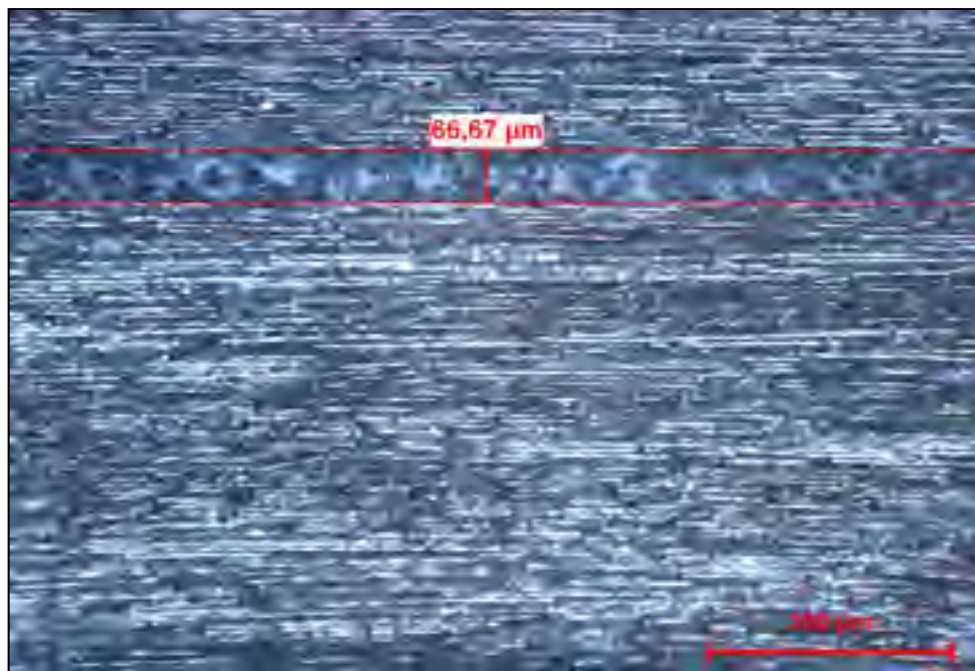
Figure-A VII-1 Mesure de l'épaisseur d'une éprouvette d'adhésif Y au microscope optique
