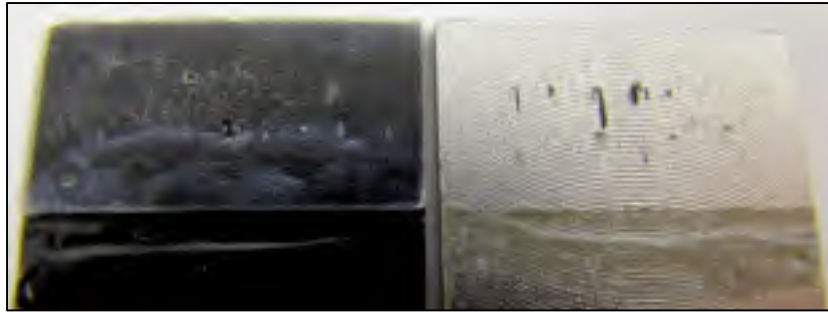
Figure 2.21 Faciès de rupture d'une éprouvette de joint collé composé d'une plaquette en matériau composite A et de l'adhésif Z conditionné pendant 177 jours en eau
