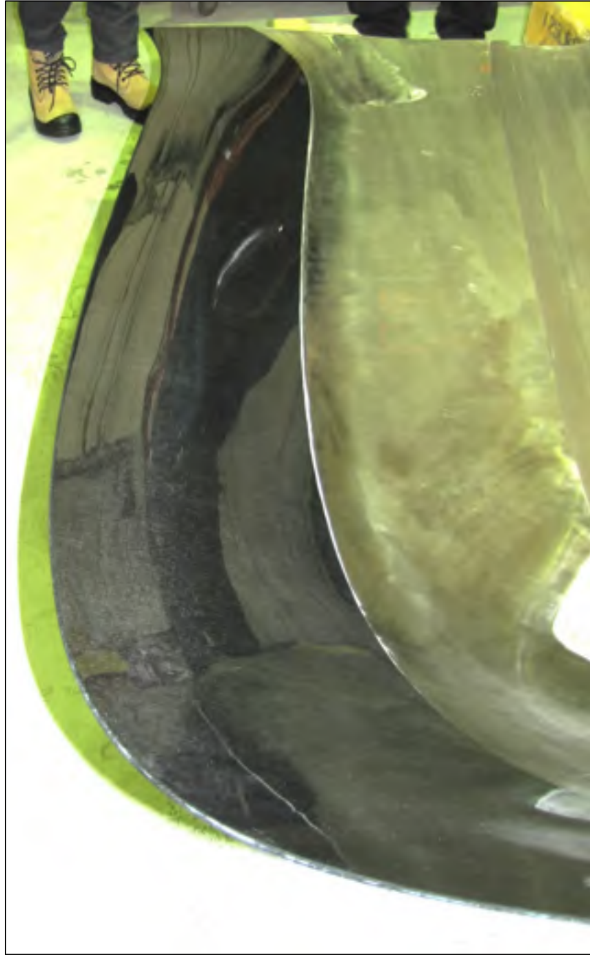
Figure-A XIV-1 Bord de fuite de l'aube du côté intrados
