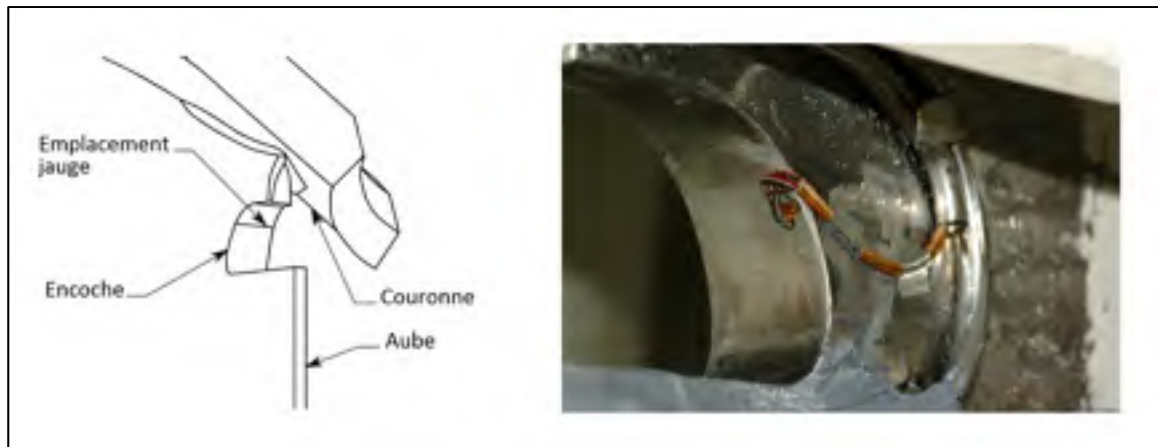
Figure 2.2 Emplacement de la jauge sur l'aube; (gauche) dessin; (droite) photo Tirée de Gagnon (2010, p. 3)
