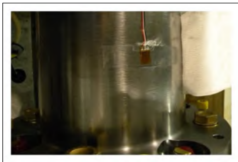
Figure 2.3 Emplacement de la jauge sur l'arbre Adaptée de Kelm Engineering, 2012
