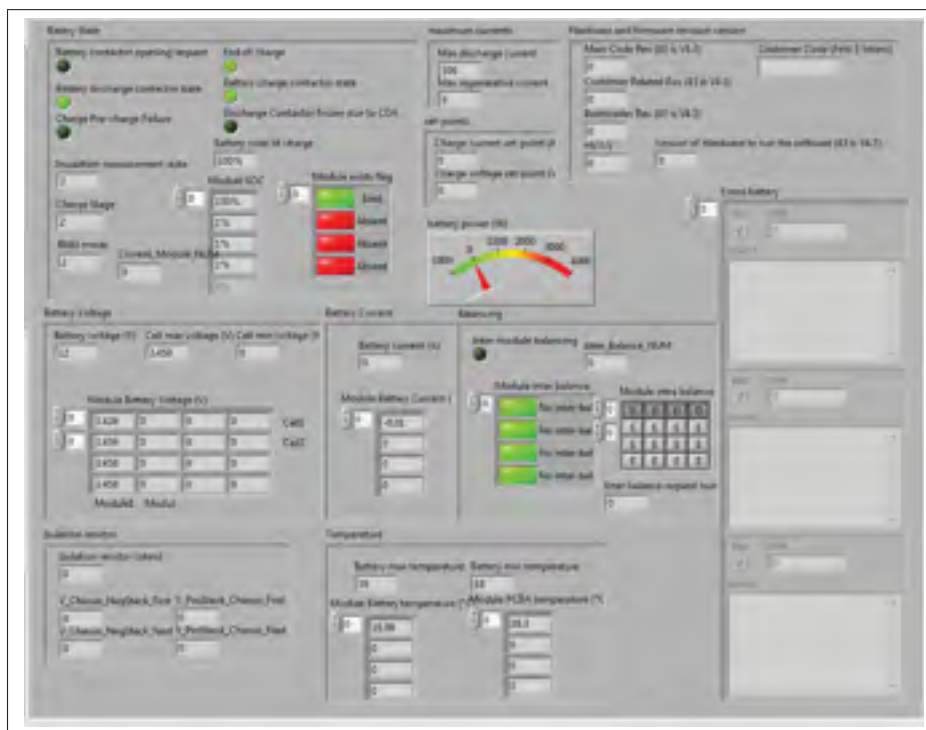
Figure 3.3 Interface LabView du BMS de la batterie Valence
