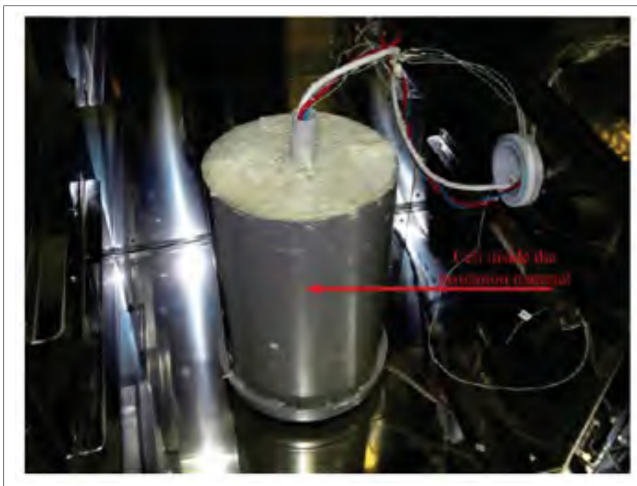
Figure 1.2 Montage expérimental d'identification de paramètres thermiques d'une cellule Tirée de Iraola (2013)
