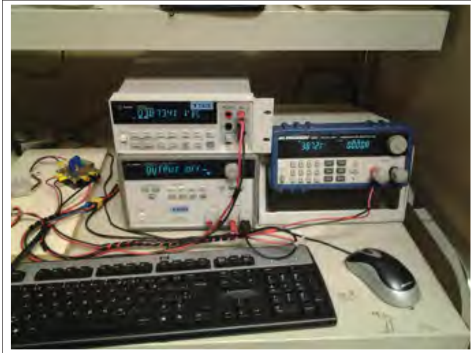
Figure 4.1 Montage expérimental de cyclage des cellules
