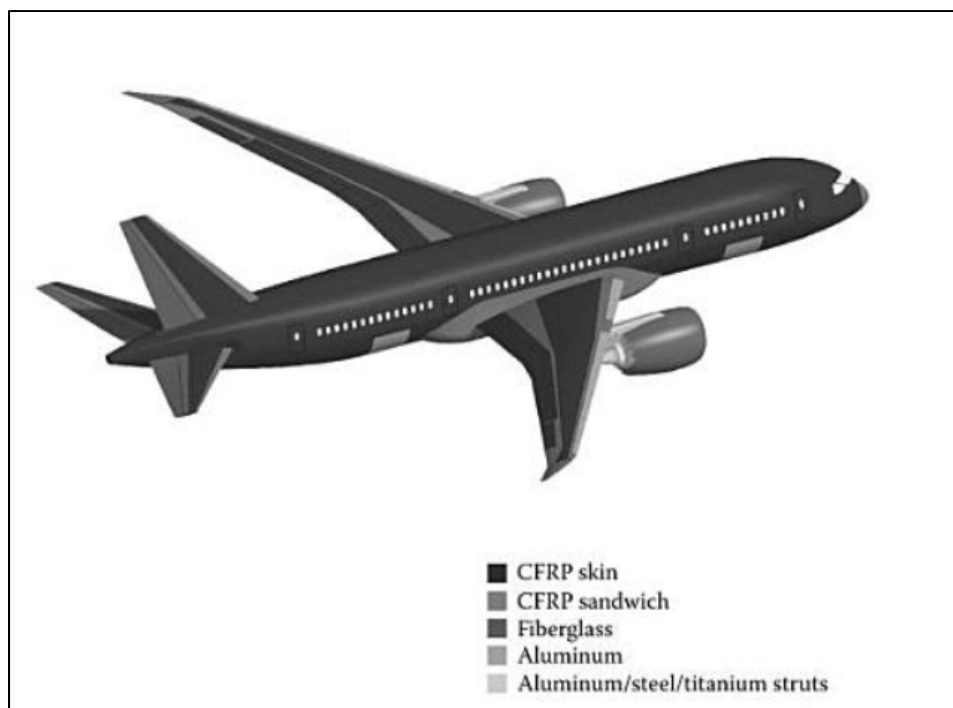
Figure 1.1 Matériaux utilisés pour la fabrication du Boeing 787 Tirée de (Gibson, 2011)
