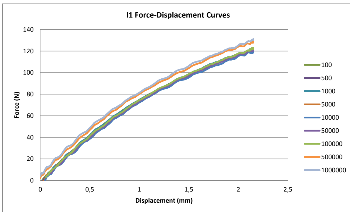
Figure A III-6 Réponse force déplacement typique en fatigue pour un échantillon infusé
