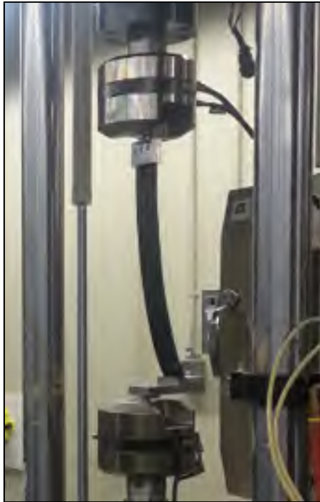
Figure A III-1 Montage de l'extrados pour les essais mécaniques
