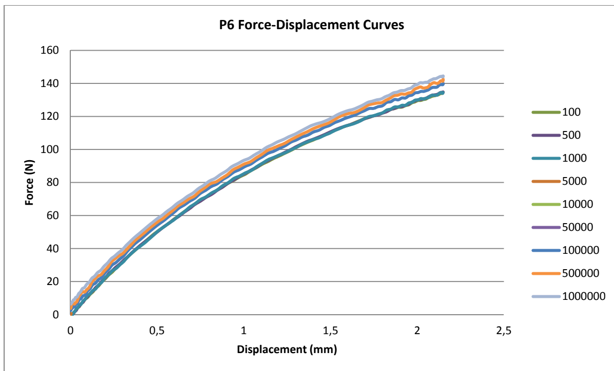
Figure A III-7 Réponse force déplacement typique en fatigue pour un échantillon de pré imprégné
