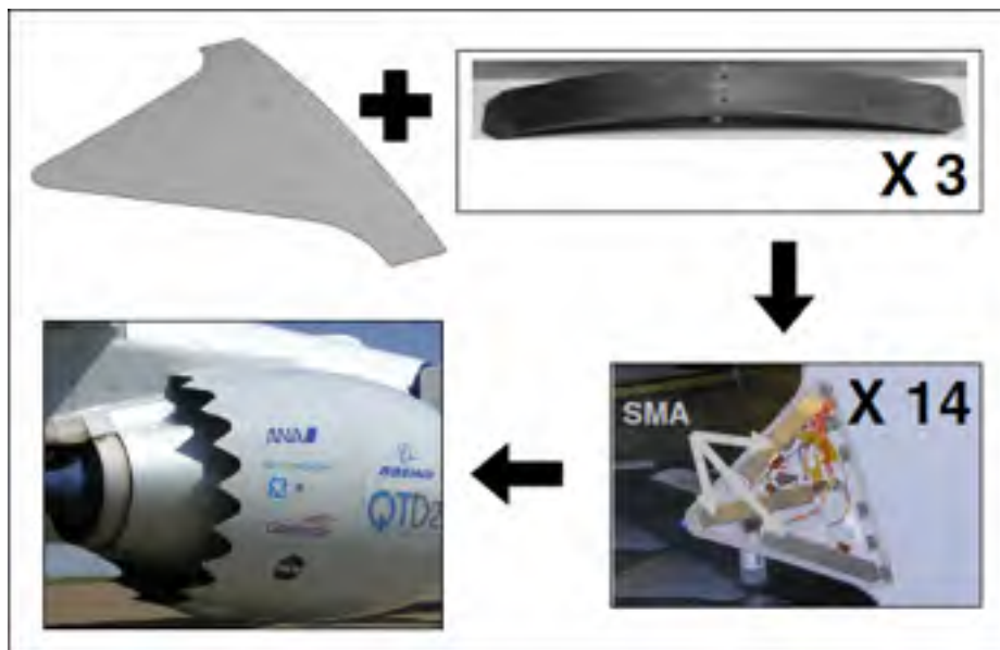
Figure 1.12 Actionneur d'AMF en flexion pour chevron adaptatif Tirée de (Hartl et al., 2010)
