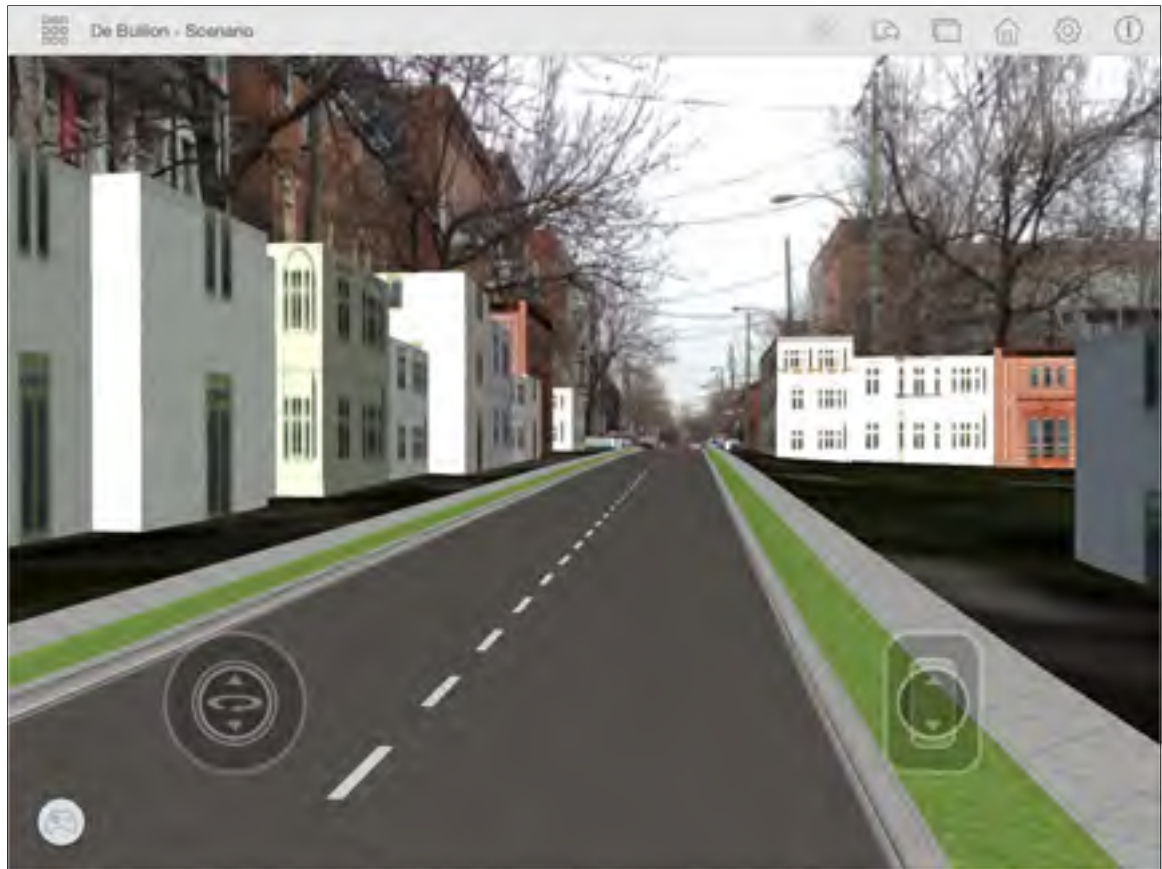
Figure 5.7 Utilisation du mode RA d'Infracore 360 : la précision de la position des objets est de plusieurs mètres
