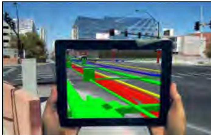
Figure 5.2 Utilisation de la RA pour visualiser l'existant inaccessible avant le début des travaux Tirée de Zeiss (2013)
