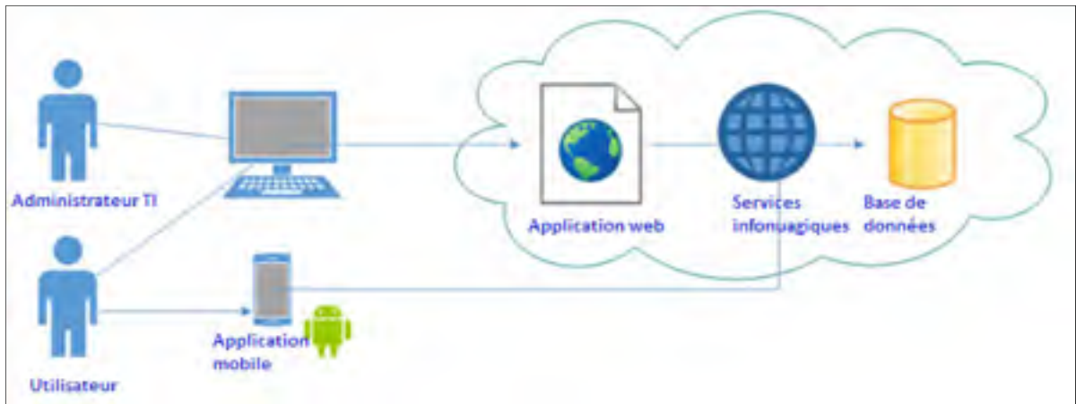
Figure 1.1 Fonctionnement d'une application infonuagique vis-à-vis des données de projet Adaptée de Ferrada et al. (2014)
