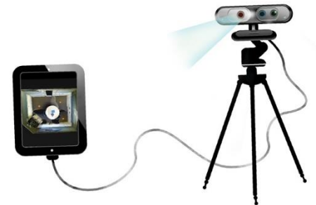
Figure 17 Caméra Matterport contrôlée par iPad (Source : www.fastcompany.com )
