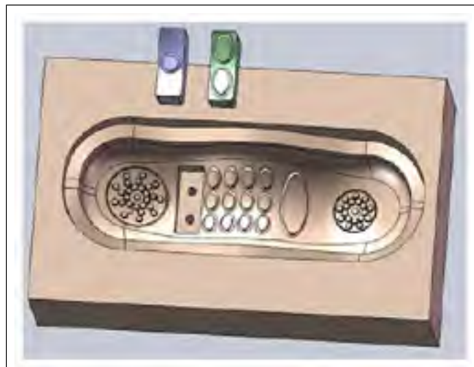
Figure 3.6 Exemple d'un moule Tirée de Kerbrat, Mognol et Hascoet (2010)
