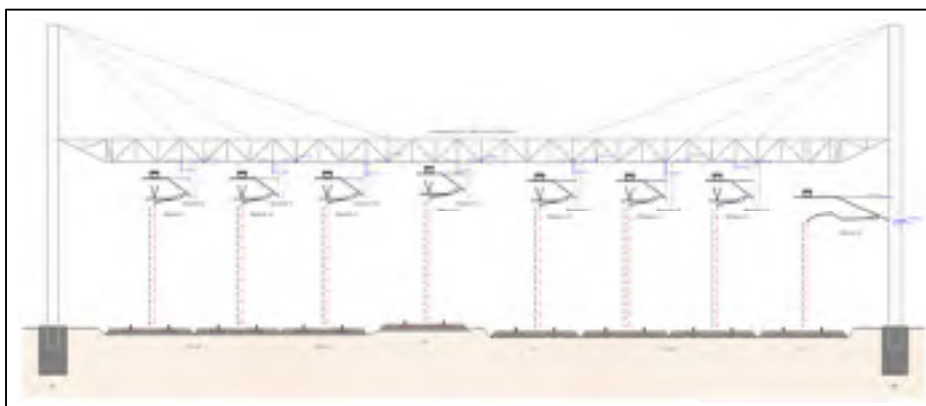
Figure 3.14 Exemple de portiques de chemin de fer Tirée de Saa et al. (2012)
