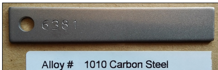
Figure 2.3 Coupon de corrosion en acier à faible concentration en carbone 1010 (3"×1/2"×1/16")
