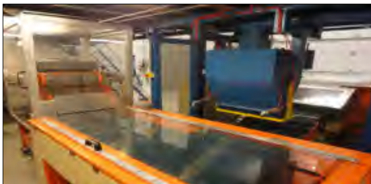
Figure 2.5 La carde et l'étaleur nappeur de la ligne non-tissé du Groupe CTT
