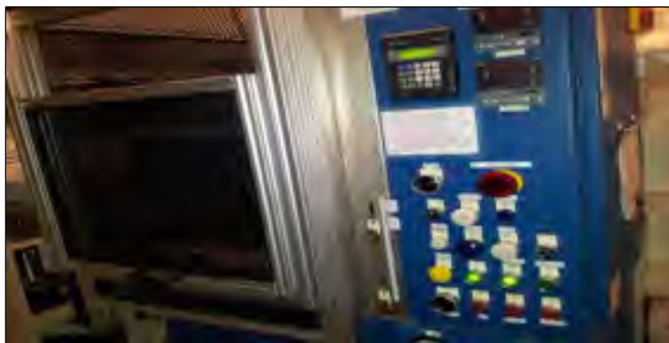
Figure 2.6 Presse chauffante utilisée pour le thermoliage des échantillons des non-tissés produits
