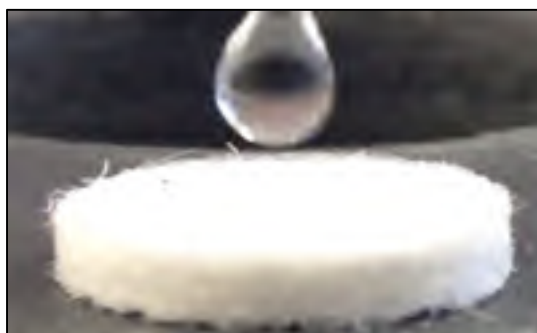
Figure 2.32 Dépôt d'une goutte d'eau sur une pastille préparée avec la fibre Bico11
