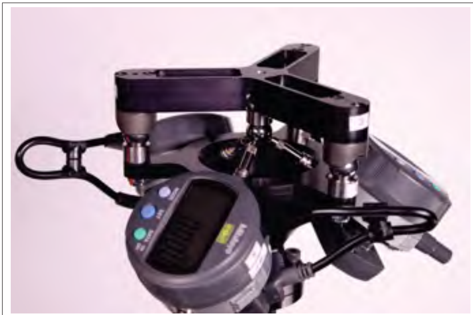
Figure 2.6 Dispositif de mise à zéro contraint sur le dispositif de mesure avec le principe d'accouplement cinématique
