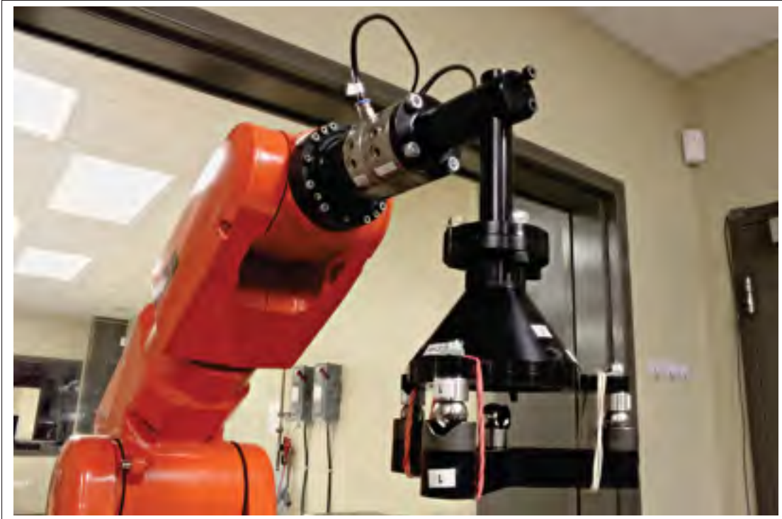
Figure 5.3 Modifications apportées au dispositif de mesure pour effectuer la validation avec l'installation expérimentale 2
