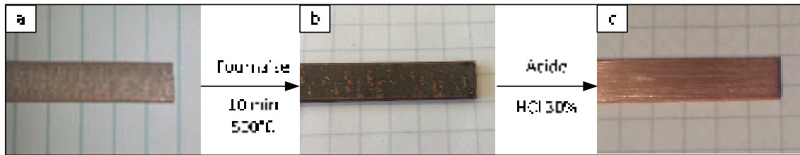
Figure 3.3 Représentation des étapes de la préparation des barres de cuivre. (a) conducteur de cuivre isolé, (b) après brulage de l'époxy, (c) après nettoyage à l'acide
