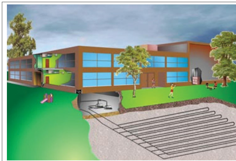
Figure 1.2 Échangeur de chaleur souterrain horizontal (boucle fermée). (Tirée de www.venmarces.com )
