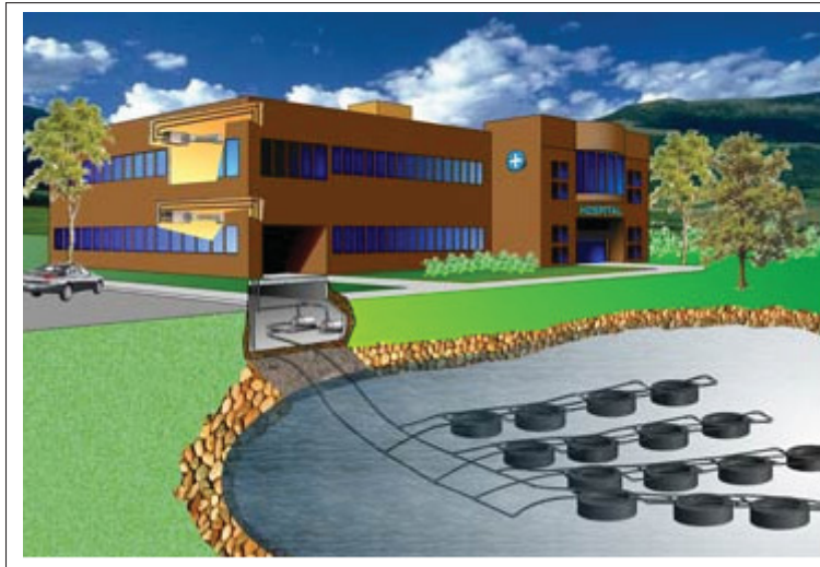
Figure 1.5 Système à boucle fermée d'eau de surface. (Tirée de www.venmarces.com )
