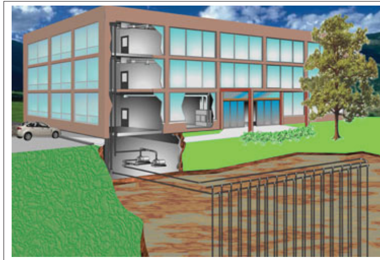
Figure 1.1 Échangeur de chaleur souterrain vertical (boucle fermée). (Tirée de www.venmarces.com )
