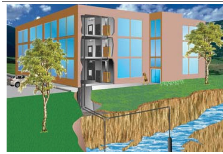
Figure 1.3 Système à eau souterraine (boucle ouverte). (Tirée de www.venmarces.com )
