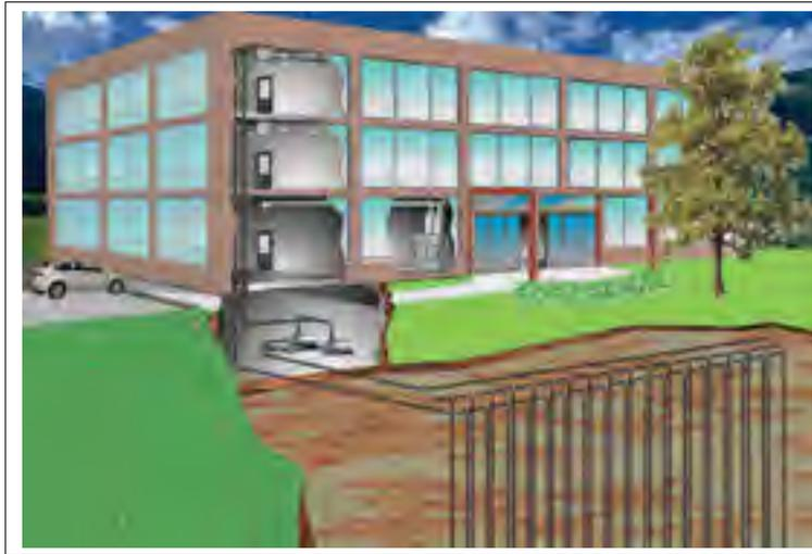
Figure 1.1 Échangeur de chaleur souterrain vertical (boucle fermée). (Tirée de [www.venmarces.com](http://www.venmarces.com))
