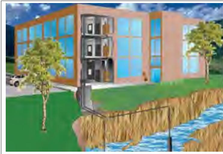
Figure 1.3 Système à eau souterraine (boucle ouverte).
