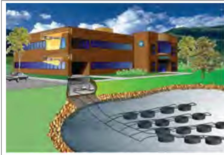
Figure 1.5 Système à boucle fermée d'eau de surface.
