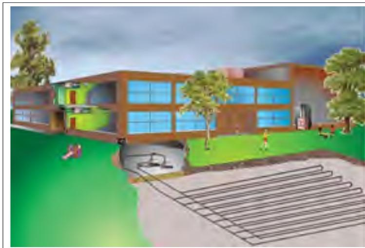
Figure 1.2 Échangeur de chaleur souterrain horizontal (boucle fermée). (Tirée de [www.venmarces.com](http://www.venmarces.com))
