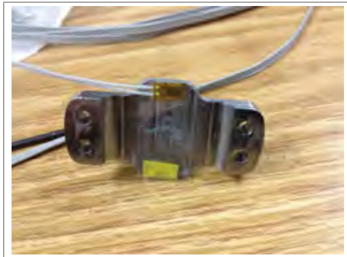
Figure 5.8 Jauges installées sur le support du bas
