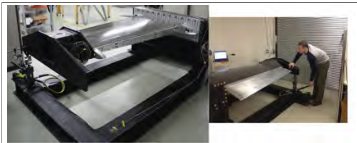
Figure 6.9 Banc de test expérimental de l'aile
