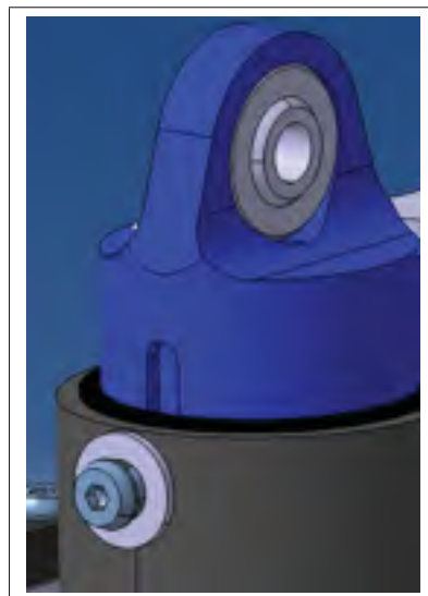
Figure 4.11 Butée et blocage de la rotation
