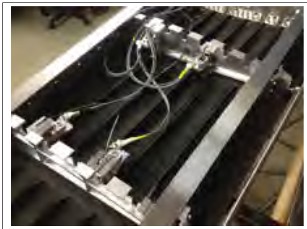
Figure 5.18 Photo de l'intégration dans l'aile des actionneurs
