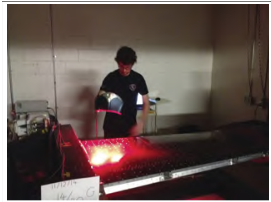
Figure 6.11 Photo du scan de la section d'aile sur le banc de test
