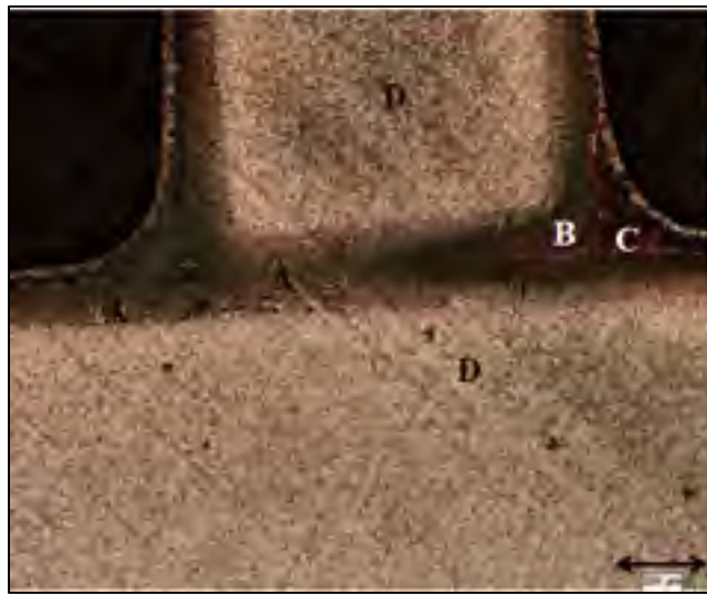
Figure 1-20 Défaut de perpendicularité dans un joint en T brasé à 900°C (Chabrol, 2014).
