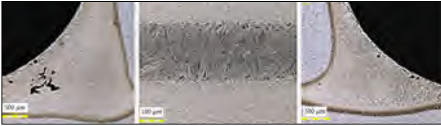
Figure 4-7 Joint brasé à 900°C pendant 120 minutes à un fini de surface de 1200 grain et de la pâte pour métal d'apport.
