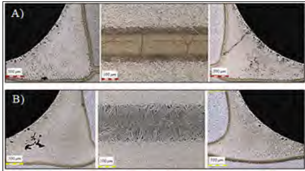
Figure 4-8 a) Joint brasé à 900°C pendant 80 minutes, b) Joint brasé à 900°C pendant 120 minutes.
