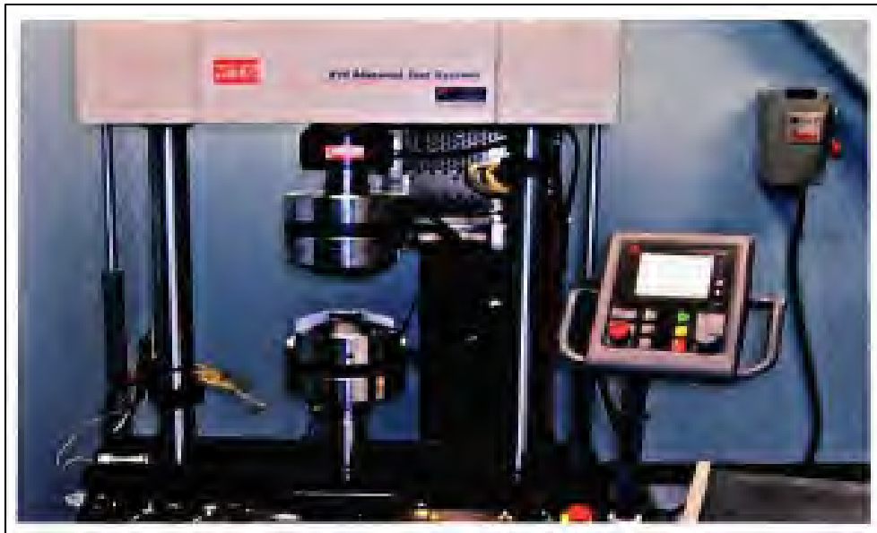
Figure 3-5 Machine MTS Landmark utilisé pour effectuer les tests de fatigue de traction à l'école de technologie supérieure de Montréal (TSOUNGUI, 2010).
