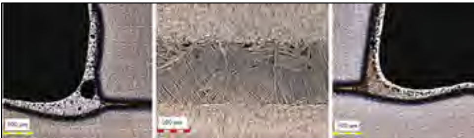
Figure 4-10 Joint brasé à 900°C pendant 140 minutes.
