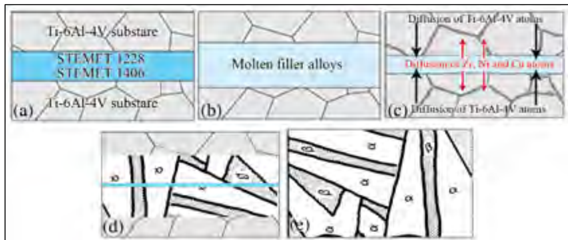
Figure 1-4 Un modèle pour décrire le processus de brasage par diffusion, (a) condition initiale, (b) dissolution du métal d'apport, (c) solidification isotherme, (d) homogénéisation et (e) développement des structures de Widmanstätten (Ganjeh et al., 2012).
