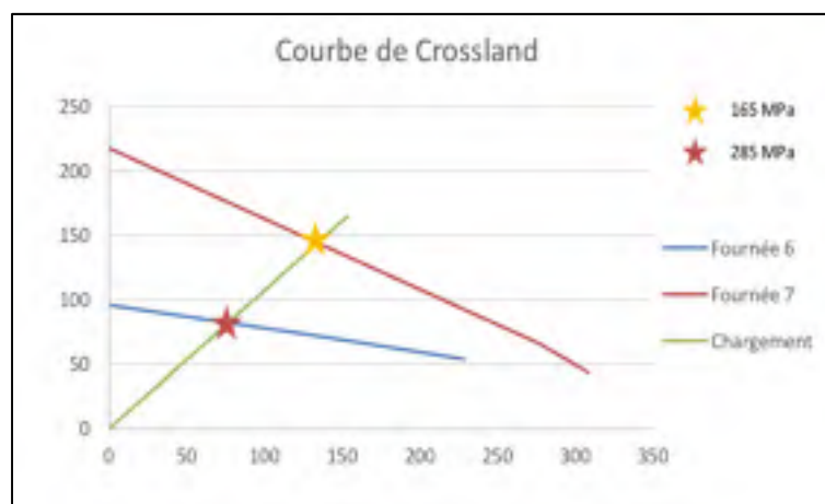
Figure 4-18 Application du critère de Crossland aux joints brasés en Ti-6Al-4V.
