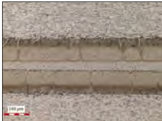
Figure 4-4 Joint brasé avec de la pâte à un fini de surface de 80 grain.
