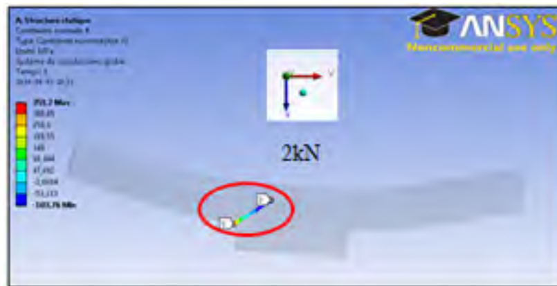
Figure 4-1 Trajectoire d'évolution de la contrainte normale (Axe X) de la flexion 3 -points Vs 4-points.
