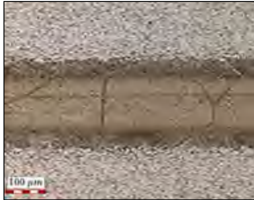
Figure 4-5 Joint brasé avec de la pâte à un fini de surface de 1200 grain.
