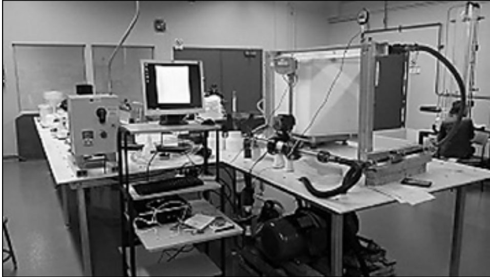
Figure 3.1 Pompe, débitmètre, conduite d'amenée et système d'acquisition de données du banc d'essais au laboratoire de l'ÉTS
