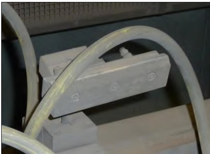
Figure 2.6 Plaque d'air comprimé pour le refroidissement des échantillons pendant la projection thermique
