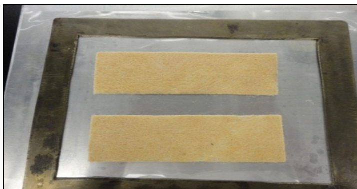
Figure 2.13 Non-tissé thermolié à la presse chauffante
