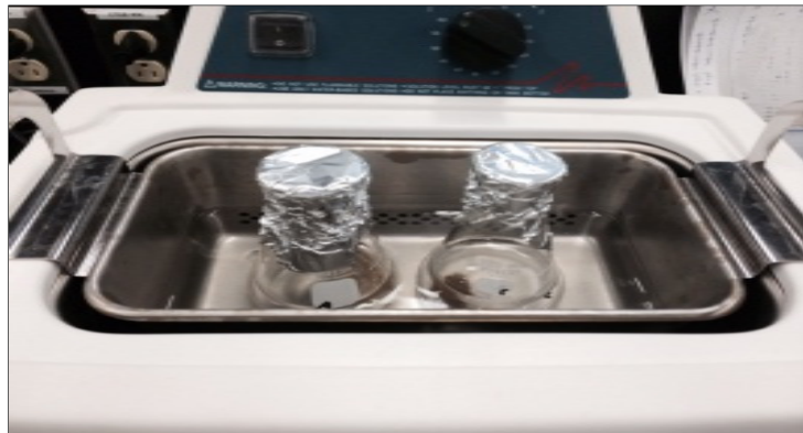
Figure 4.4 Principe du traitement au bain aux ultrasons
