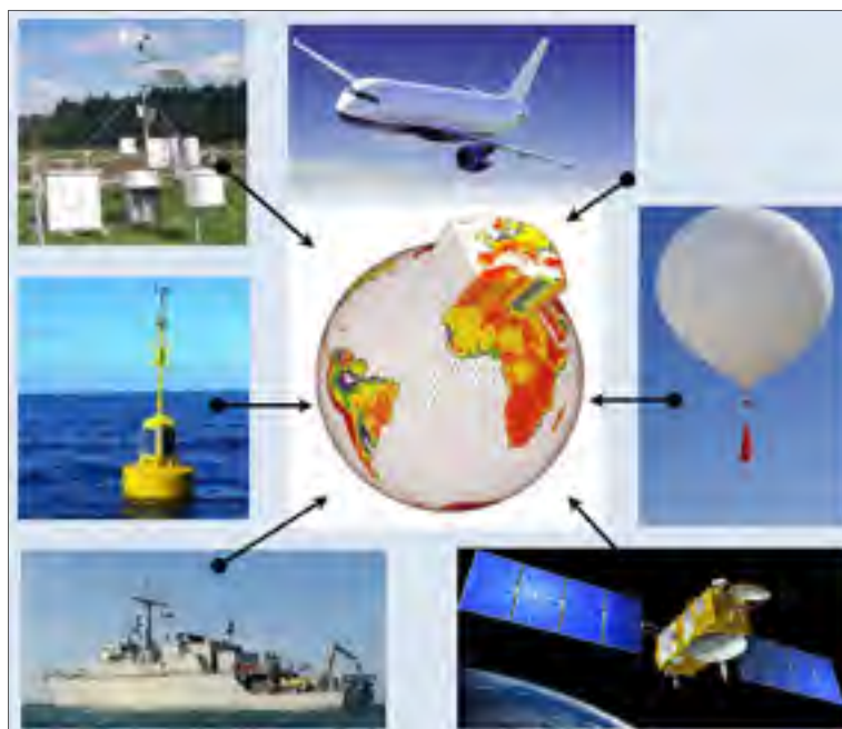
Figure 2.6 Illustration des principales sources de données d'observation assimilées dans les réanalyses
