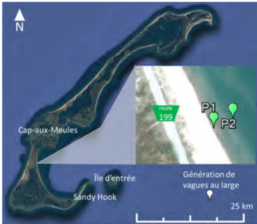
Figure 3.3 Position des deux points de calcul utilisés (P1 et P2), position du point de génération des vagues au large et la position des barrières morphologiques du secteur de la baie de Plaisance
