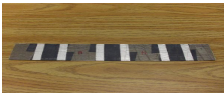
Figure 7-15 Photographie des plaquettes d'essai sur les peintures/rubans anti-effluves
