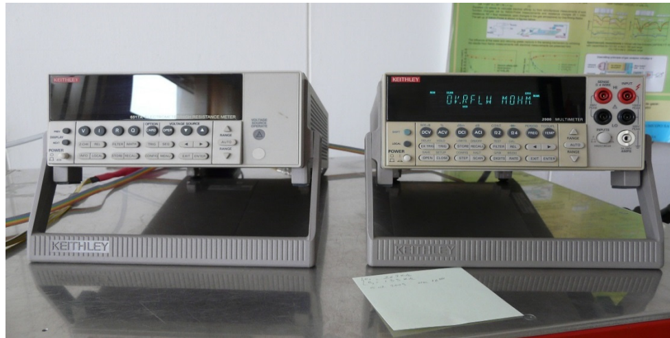
Figure 2-4 Électromètre Keithley modèle 6517A et multimètre Keithley modèle 2001
