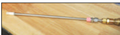
Figure 2.10 Assemblage d'un tube rigide contenant une pierre poreuse
