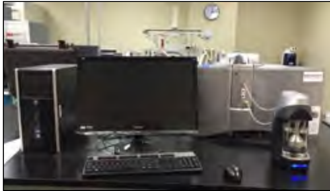
Figure 2.4 Granulomètre laser Mastersizer 3000 de Malvern Instruments
