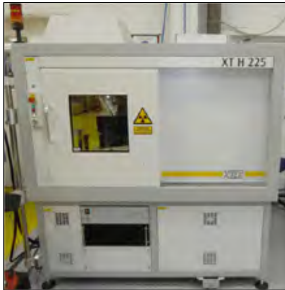
Figure 2.6 Tomodensimètre XTH225 Adaptée de Nikon Metrology (2012)
