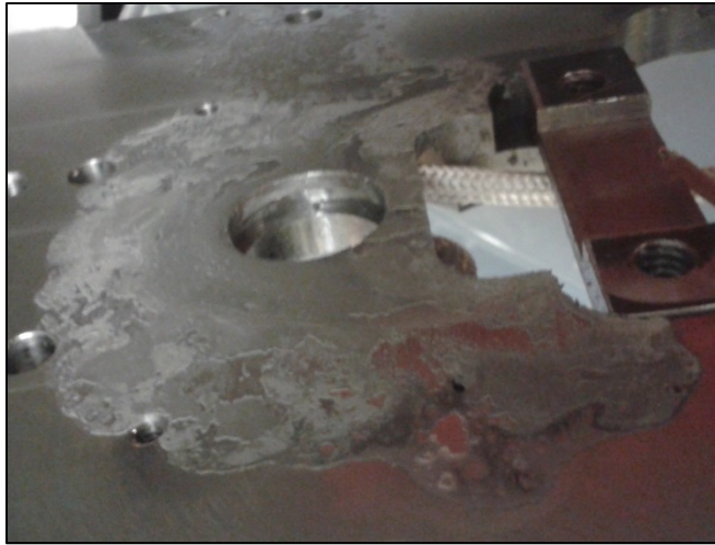
Figure 1.16 Exemple d'infiltration de mélange dans un mécanisme d'une presse à injection qui doit être nettoyé
