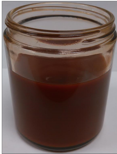
Figure 2.13 Émulsion huile de pyrolyse/diesel.
