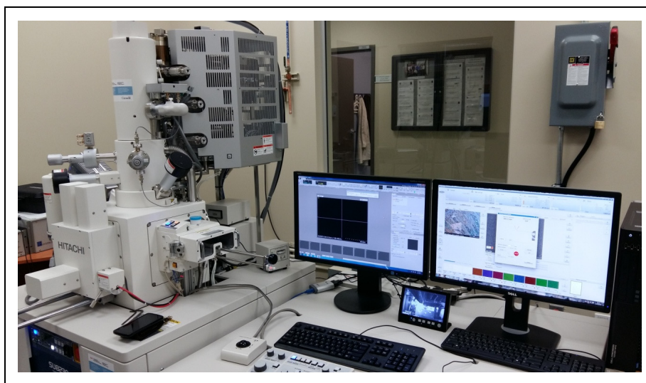
Figure-A XXIV-1 Microscope électronique à balayage de modèle Hitachi SU-8230
