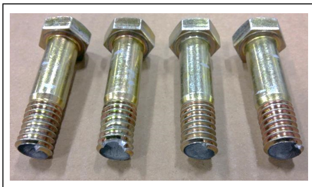
Figure 7.7 Boulons inférieurs sectionnés lors des essais mécaniques
