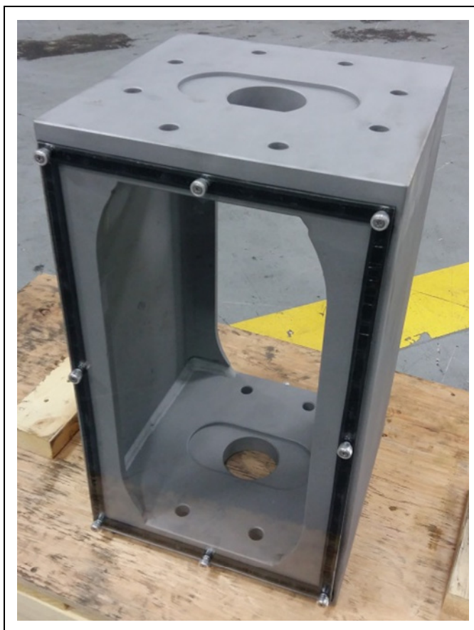
Figure 6.14 Prototype nettoyé au jet de sable et gardes transparents assemblés
