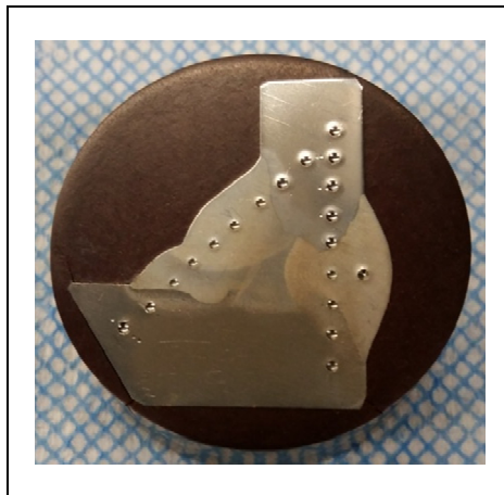
Figure 6.7 Échantillon utilisé pour les essais de dureté Rockwell
