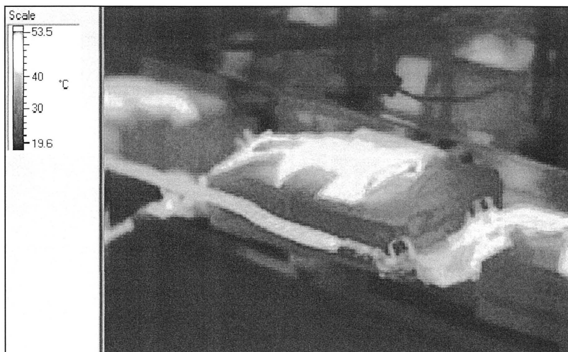
Figure 5.11 Photographie thermique d'une inductance.
