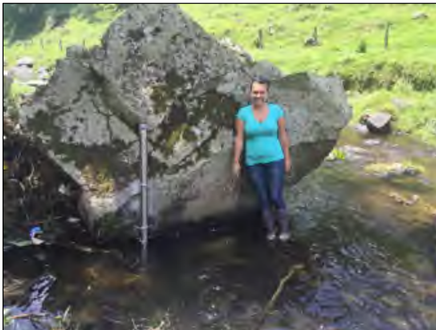
Figure 4.18 Station de mesure des niveaux d'eau installée sur le parcours de la rivière Naolinco
