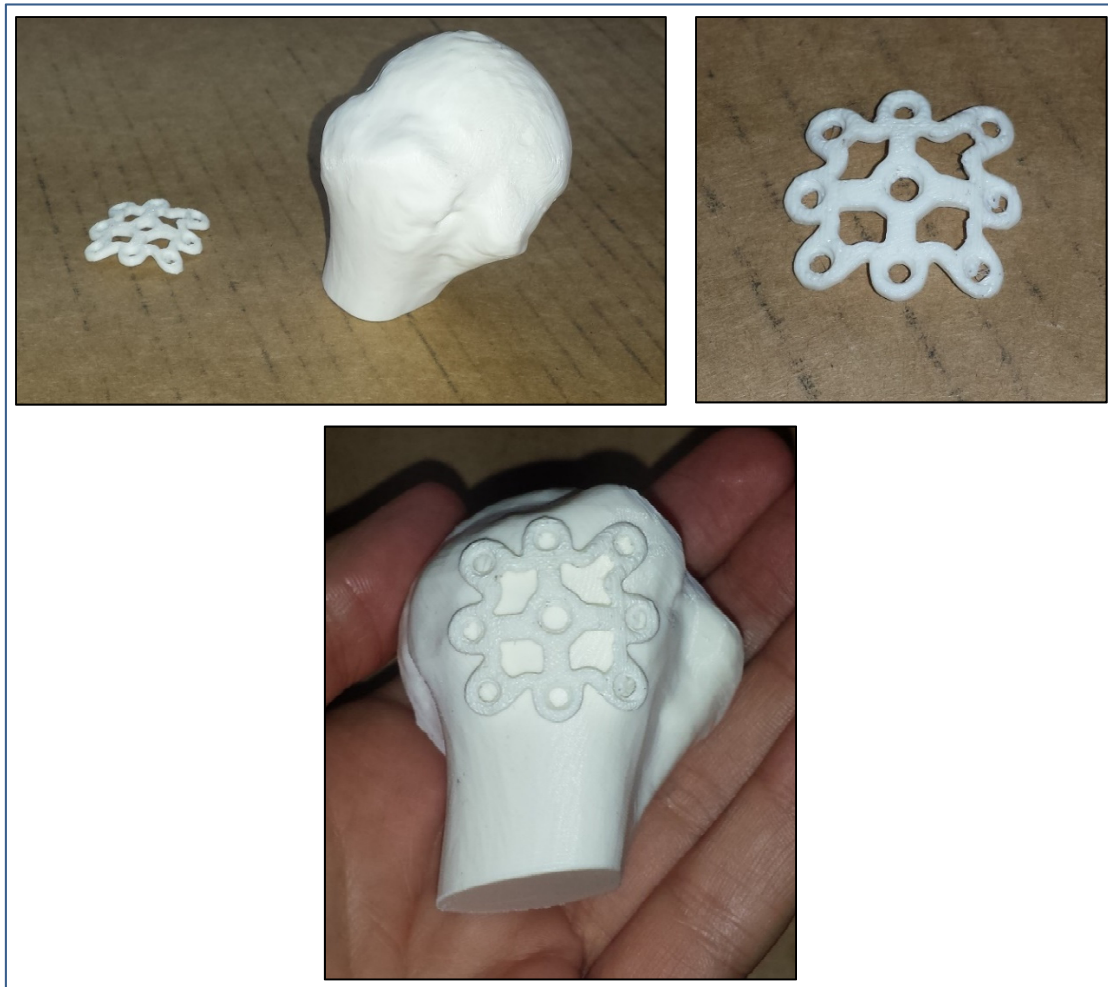
Figure 5.1 Impression du prototype de plaque et de l'humérus proximal droit
