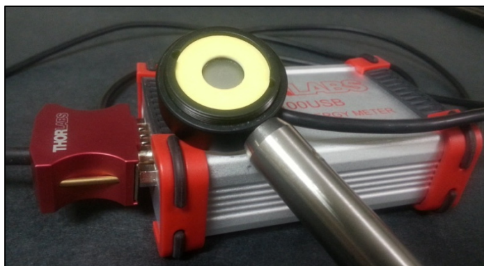
Figure 5.3 Mesureur de puissance Thorlabs
