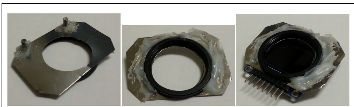
Figure 5.4 Gabarit pour aligner l'écran au photodétecteur, à gauche le dessous, au centre le dessus, à droite une fois monté
