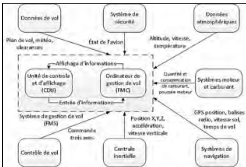
Figure 1.3 Interface du système de gestion de vol avec les autres systèmes de l'avion
