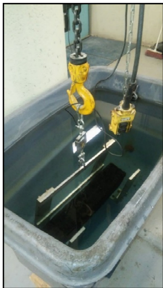
Figure 3.5 Photo illustrant la pesée hydrostatique d'une plaque
