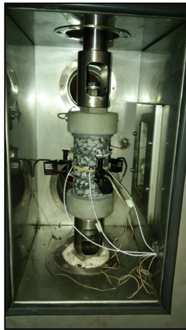
Figure 3.8 Illustration d'une éprouvette montée dans la presse pour un essai de module complexe
