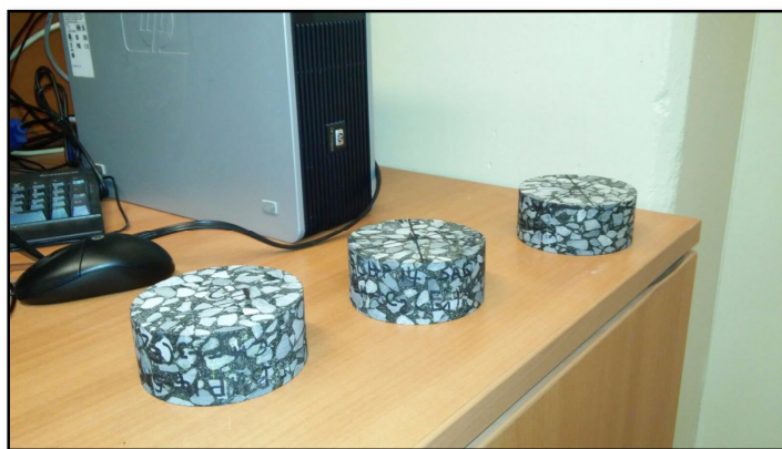
Figure 3.9 Éprouvettes extraites des carottes in situ pour les essais de module de rigidité
