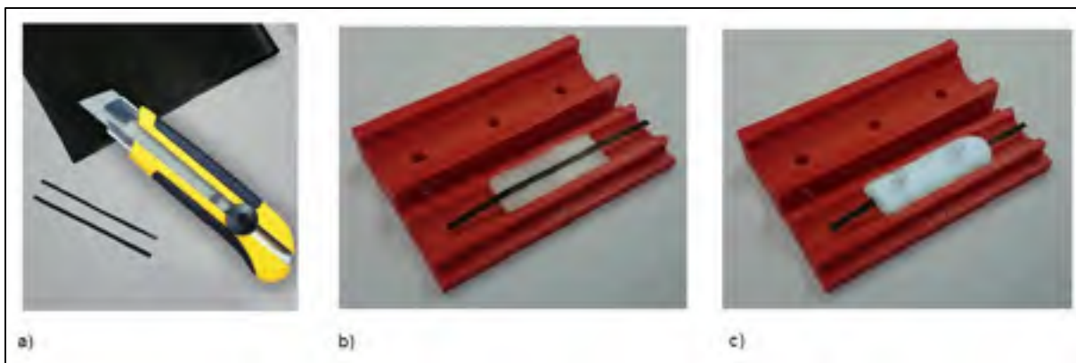
Figure 4.13 (a) Découpe des filaments de polymère (b) Insertion du filament au centre de la mousse de silicone (c) Moulage final du SMEI
