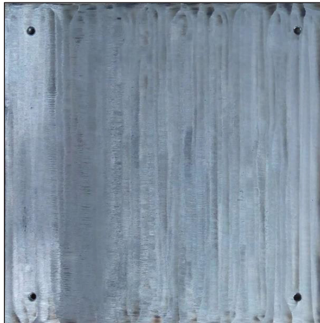
Figure 3.12 Meulage avec chevauchement de passes
