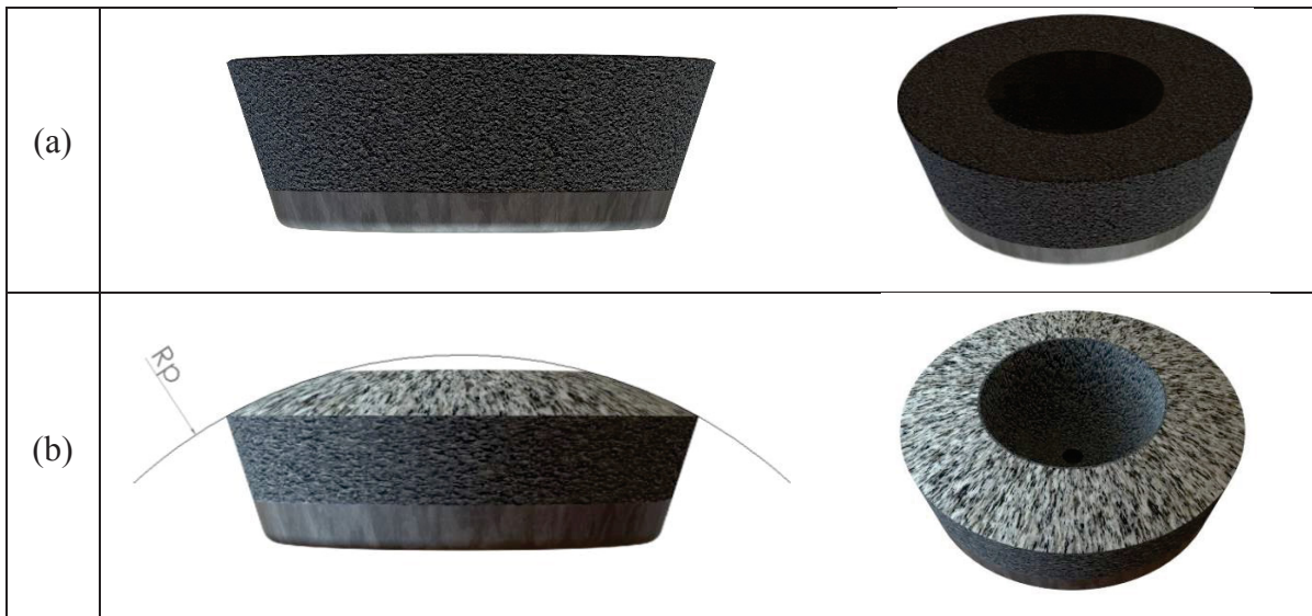
Figure 2.2 (a) Meule neuve (b) Meule profilée avec un profil sphérique
