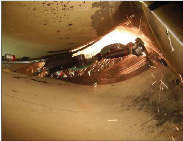
Figure 1.13 Robot monté sur une turbine (Rafieian, Hazel, & Liu, 2014)
