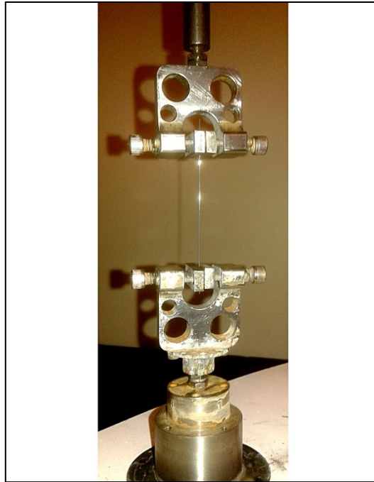
Figure 4.3 Échantillon de filament monté sur la machine électromagnétique
