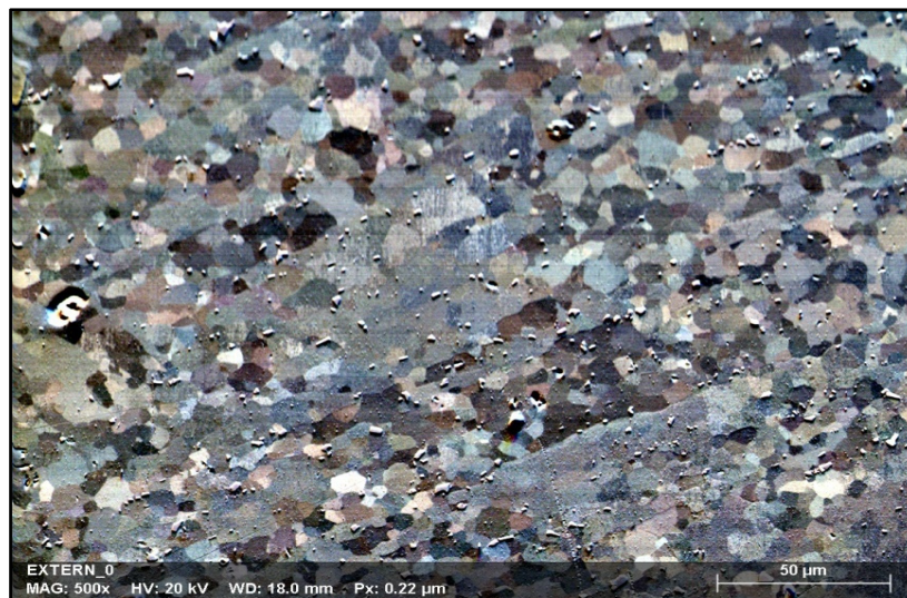
Figure-A I-3 Centre de la soudure correspondant à la zone III de la figure 3.11
