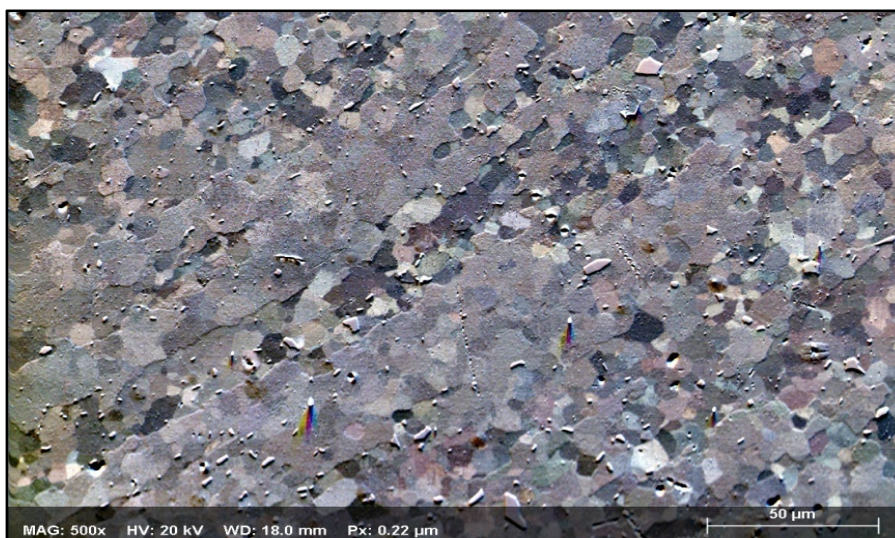
Figure-A I-2 Centre de la soudure correspondant à la zone II de la figure 3.11
