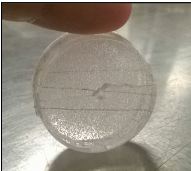
Figure 2.4 Échantillon de polyester contenant les fibres de chanvre
