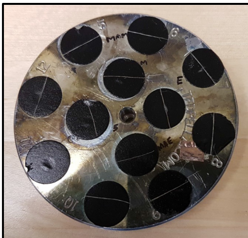
Figure 2.6 Échantillons de plusieurs amas de chanvre placés sur des pastilles
