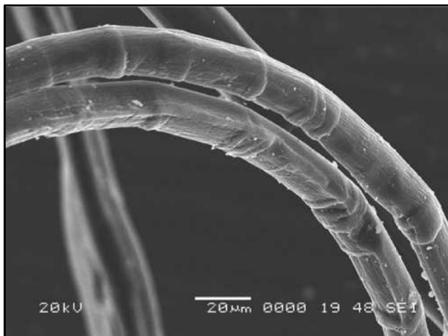
Figure 1.10 Zone de défauts sur des fibres de chanvre Tirée de Balet (2013, p.11)
