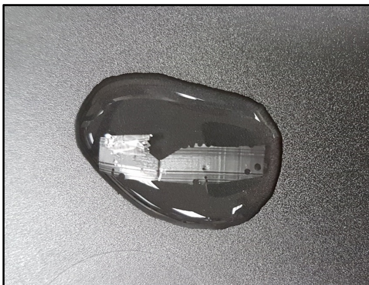
Figure 2.5 Coupe de l'échantillon sous azote liquide
