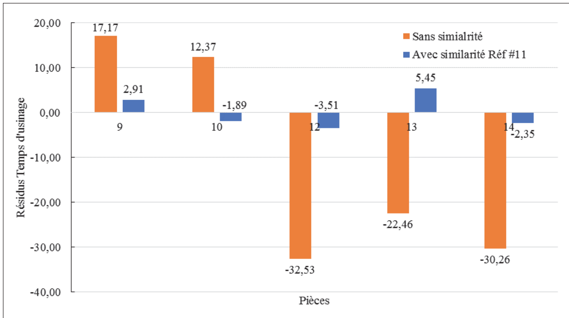
Figure 6.22 Influence de la similarité sur les résidus du temps d'usinage pour la pièce #11
