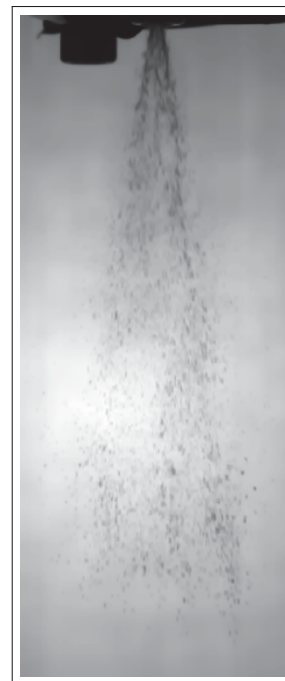
Figure 3.18 Image reconstruite du spray
