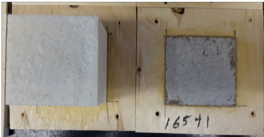
Figure 2.42 Rupture de l'interface parement/mousse lors d'un essai de traction
