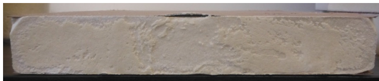
Figure 2.33 Exemple d'échantillon non complet mais exploitable après découpe (RAC)
