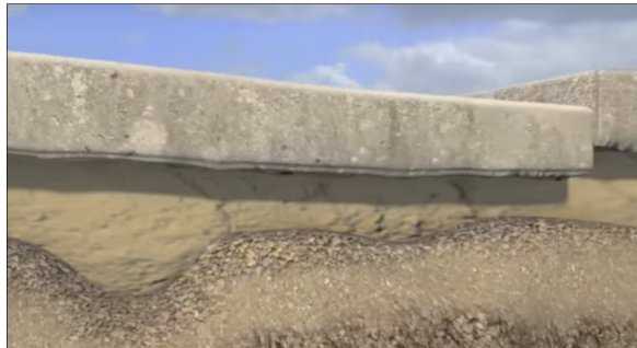
Figure 1.17 Polyuréthane injecté sous la route pour le rehaussement de la chaussée Tirée de (URETEK, 2016)
