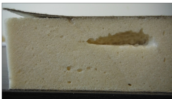
Figure 2.27 Exemple de défaut causé par une quantité de pentane trop importante
