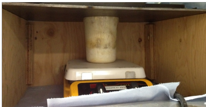
Figure 2.7 Installation du moule sur le support en bois avec le b cher de m lange
