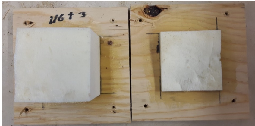
Figure 2.41 Rupture de la mousse lors d'un essai de traction
