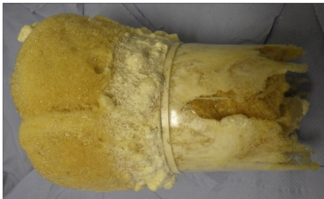
Figure 2.9 Échantillon de polyuréthane obtenu à l'aide du mélangeur magnétique
