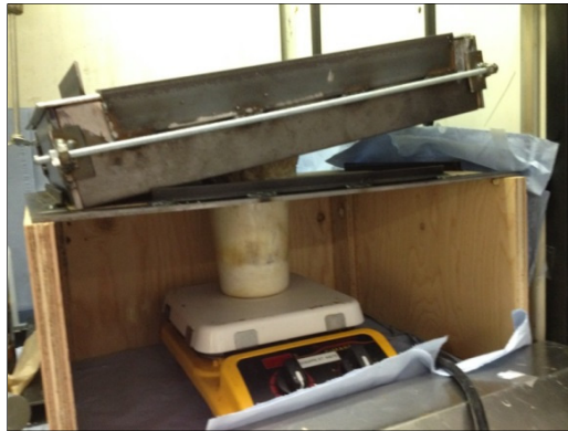
Figure 2.8 Vue du moule après l'essai à l'aide d'un mélangeur magnétique
