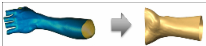
Figure 3-8 Conversion d'un nuage de points en modèle surfacique Tirée de Kim et Jeong (2015), p. 5153
