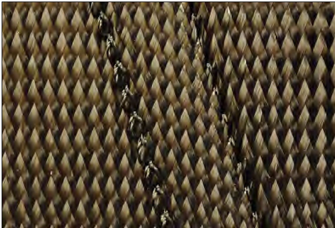
Figure 4.16 Le verrouillage des fibres à l'intérieur des zones de couture sous l'effet de la compression latérale et du cisaillement
