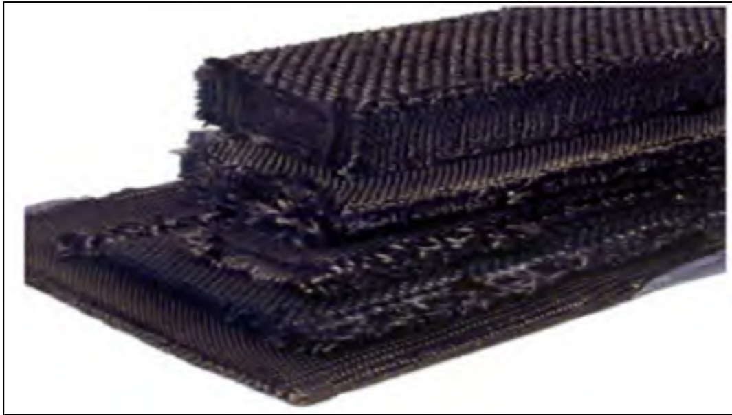
Figure 1.9 Exemple de préforme 3D 3Weave™ (Compagnie américaine 3Tex)
