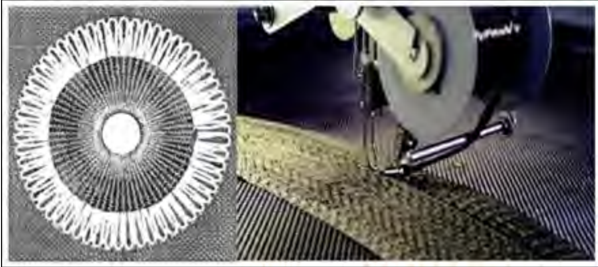
Figure 1.6 Procédé de broderie (Adaptée de Brandt et al., 2005)
