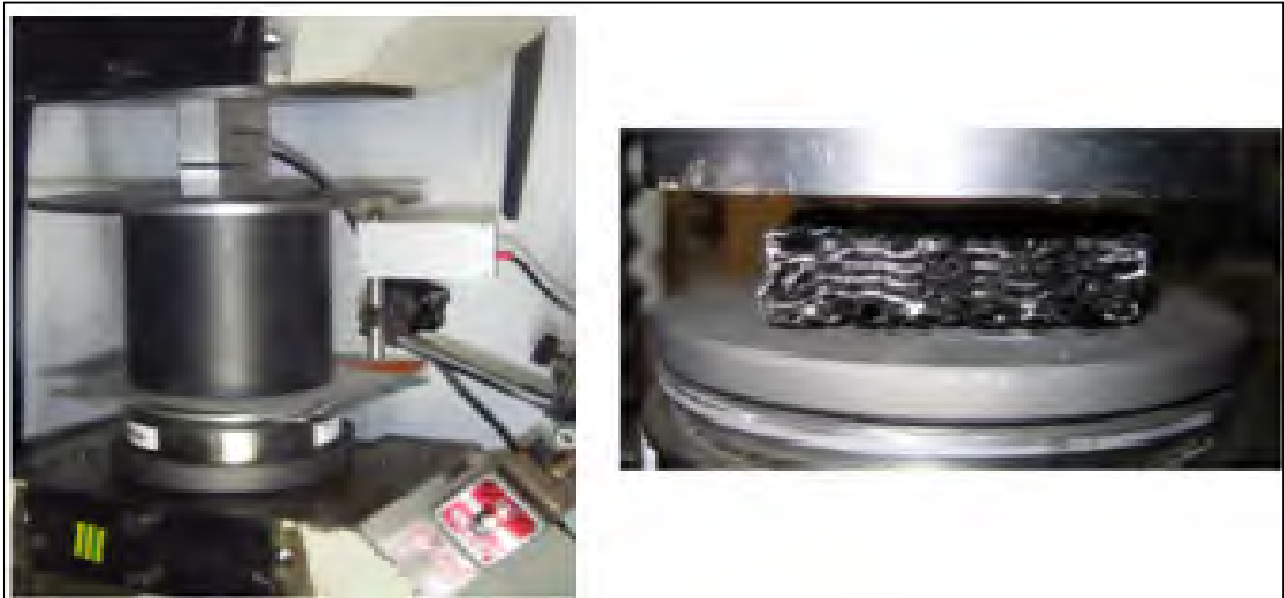
Figure 2.17 Dispositif d'essai de compaction d'interlock (De Luycker, 2009; Ogale et Mitschang, 2007)
