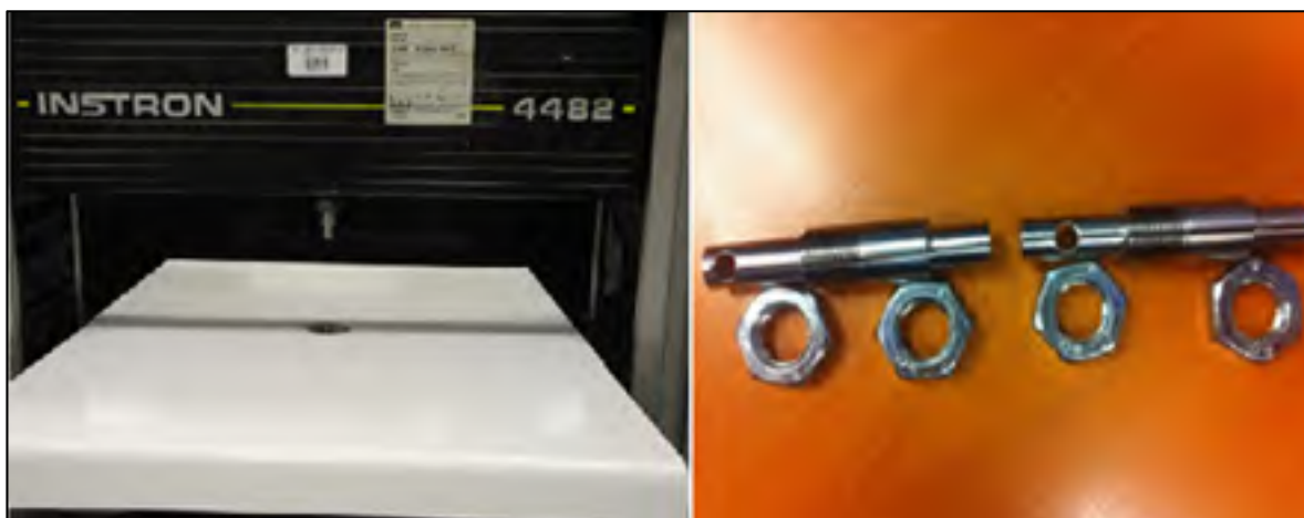
Figure 3.4 Dispositif de compaction localisée : Machine Instron 4482 et plateaux de compaction
