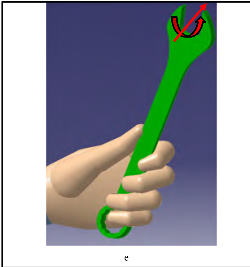
Figure 2.5 – Force(s) extérieure(s) auxquelles doivent résister les préhensions sur : a - la pince, b – le tournevis, c – le tournevis électrique, d – le marteau, e - la clé anglaise (suite)
