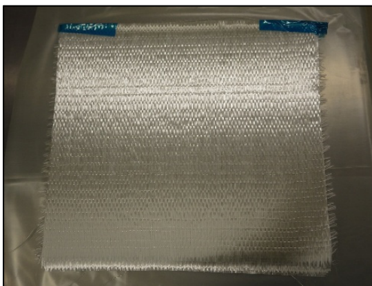
Figure 2.3 Étape d'empilement des plis (fibres de verre)
