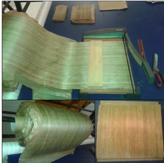
Figure 2.2 Étape de découpe des plis Tirée de Delahaigue, 2015
