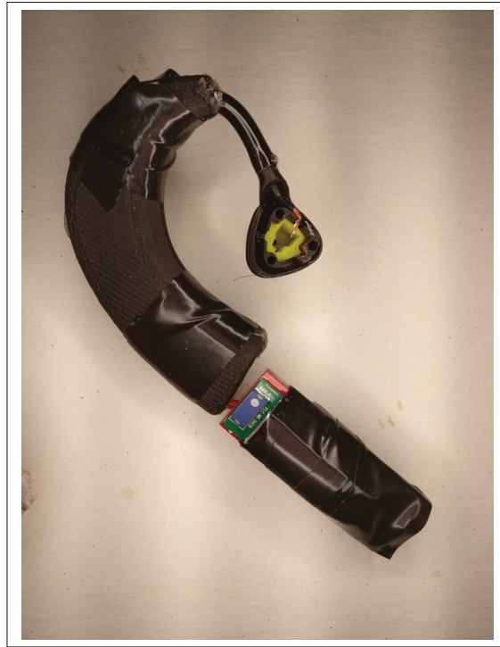
Figure 0.3 Prototype de bouchon numérique intra-auriculaire avec UMI et module Bluetooth
