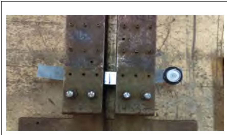
A V-1 : Installation de l'éprouvette dans le gabarit de découpe EDM
