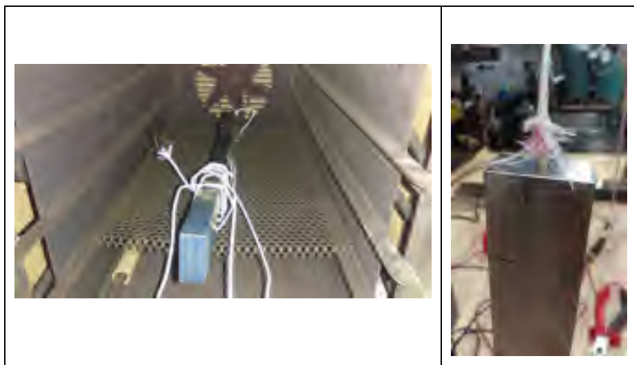
A VI-2 : Installation des thermocouples sur l'éprouvette de flexion quatre points
