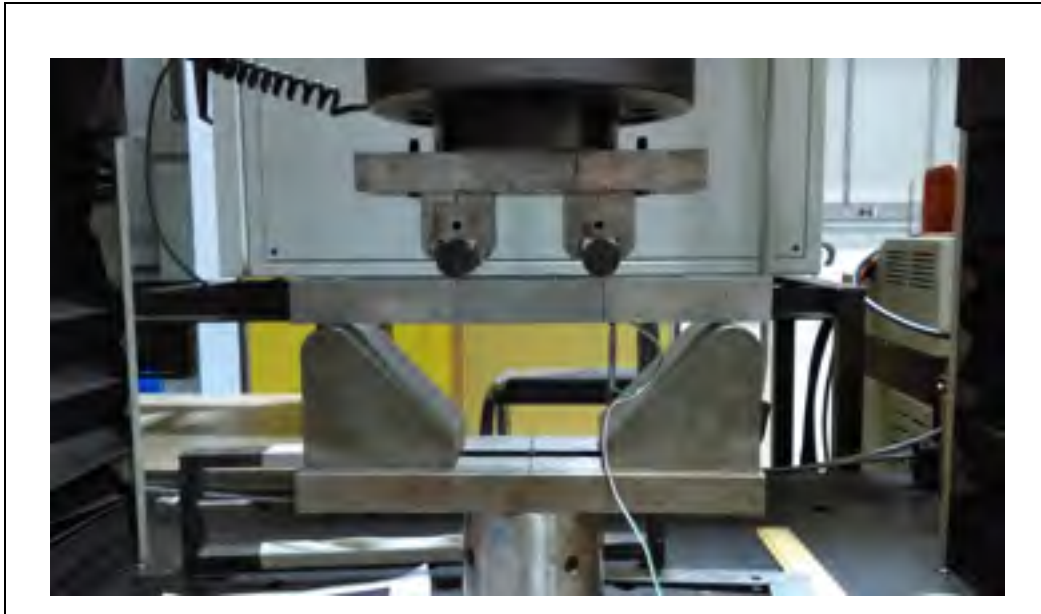
Figure 4-5 : Montage expérimental pour la flexion quatre points
