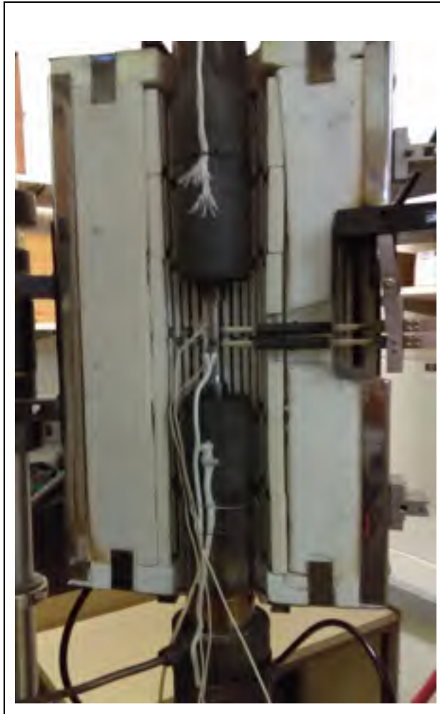
A III-2 : Éprouvette de traction à chaud installée
