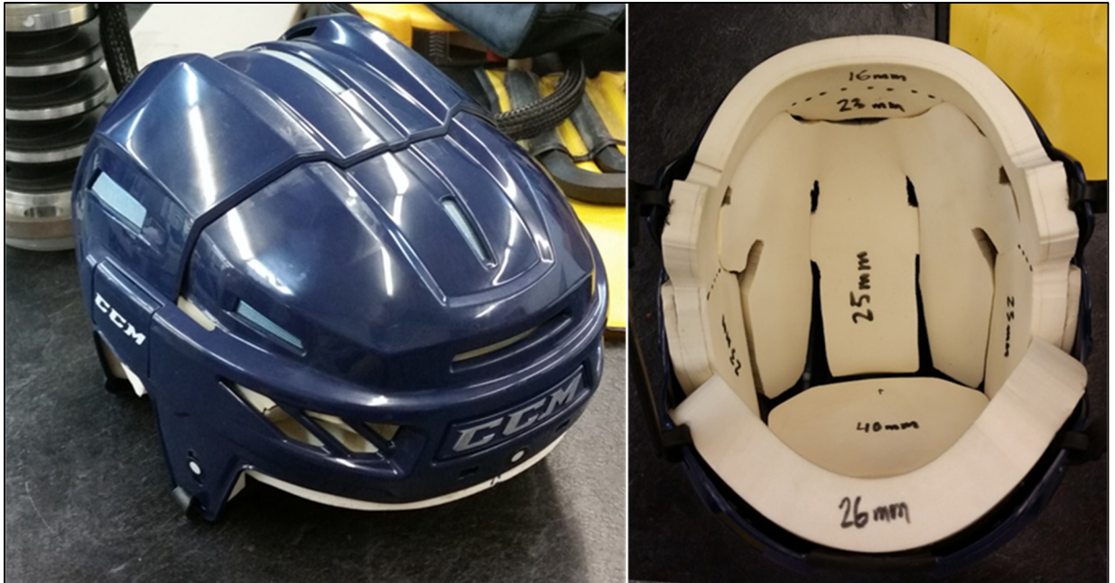
Figure 6.1 Casque de hockey utilisé pour le projet – Coque 3DS et mousse VN602
